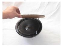
Deckel aufsetzen, und mit Mutter sichern. Unterlegscheibe unter Mutter nicht vergessen
